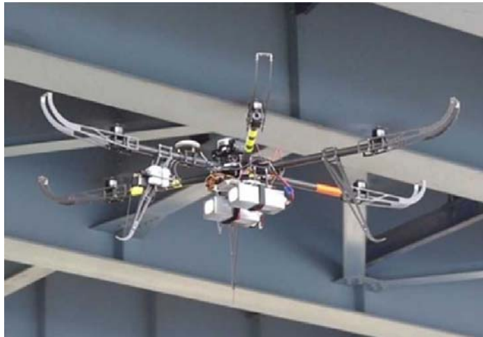
図-11 橋梁維持管理に資するロボットの一例
