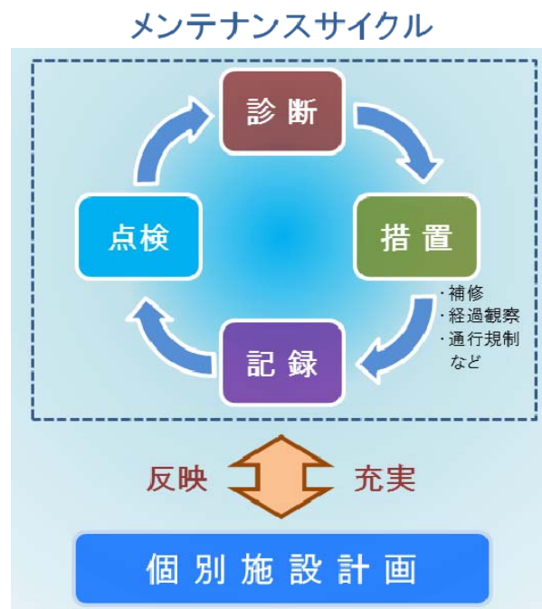
図-9 松島有料道路の点検から補修の流れ
